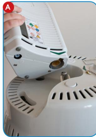
• Présentez et engagez le portable verticalement dans l'empreinte, comme indiqué sur la photo. La borne femelle du portable doit être bien en face de la borne mâle de la réserve.
