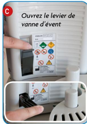
• Maintenez cet appui avec une main, et de l'autre main, ouvrez le levier de la vanne d'évent à fond. Un sifflement sourd dû à l'échappement d'oxygène gazeux se fait alors entendre pendant toute la durée de remplissage. Durant le remplissage relâcher régulièrement (toutes les 20 sec) la vanne d'évent, afin qu'elle ne givre pas.
