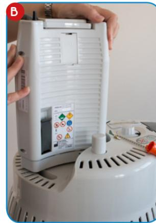
• Exercez des deux mains une pression verticale sur le portable, dans l'axe de la borne de remplissage, bien à fond.
